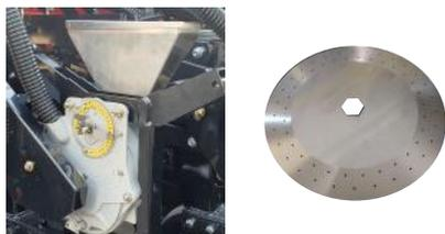
Sistema de seleção e distribuição de sementes pneumático por aspiração negativa (vácuo). A regulagem de distribuição é efetuada através de seletor e da variação da pressão negativa.
