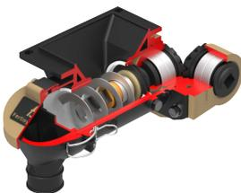
O sistema Fertisystem conta com rosca sem-fim e eixo rotativo, o que garante a dosagem sem perdas e desperdícios, distribuição uniforme em qualquer tipo de terreno.
