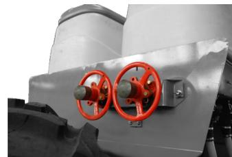
Regulagem de vazão das sementes, volantes de regulagens efetuam o deslocamento lateral dos rotores dosadores.
