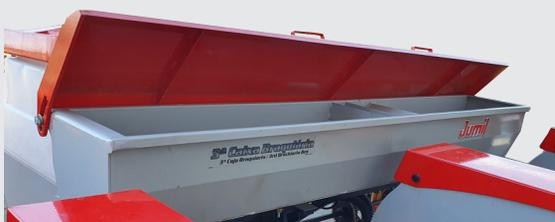
Tem a função de efetuar semeadura de sementes finas gramíneas. Essa técnica é utilizada para semear grãos finos nas entrelinhas do plantio principal a fim de formar cobertura e proteção do solo (retenção de umidade).
