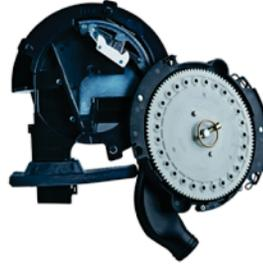
**vSet** possui um disco plano com uma única configuração de vácuo. Ele libera as sementes centralizadas no tubo, o que é muito importante para o espaçamento e possui um singulador flutuante de cinco pontas que assegura que nenhum tipo de dupla ocupe o mesmo furo no disco. Uma semente é travada no furo e a outra é extraída pelo singulador. Sempre.
