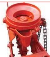
Bloco adubador com escala de regulagem, sobreposta e prato distribuidor acionado por engrenagem e pinha. Possui direcionador e sistema mexedor do adubo. (padrão)
