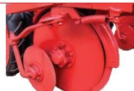
Disco duplo paralelo de 13". Possui limpador interno dos discos para evitar o travamento. Equipado com disco cobridor de sulco com regulagens de ângulo para cobertura.
