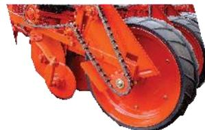
Roda traseira com banda de borracha com alívio central para a compactação da semente e fechamento do sulco. Montada com sistema de regulagens de profundidade.
