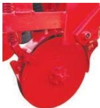
Disco duplo paralelo de 13". Possui limpadores internos e externos, condutor de adubo removível para limpeza e haste com mola para regulagem de pressão do disco sobre o solo.
