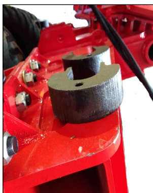
CALÇO PARA NIVELAMENTO DA MÁQUINA MANDATÓRIO CILÍNDROS CENTRAIS (calço grosso)
