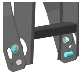
Figura 22: Trava da escada em transporte.
