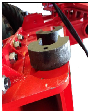
CALÇO PARA NIVELAMENTO DA MÁQUINA MANDATÓRIO CILINDROS CENTRAIS (calço grosso)
